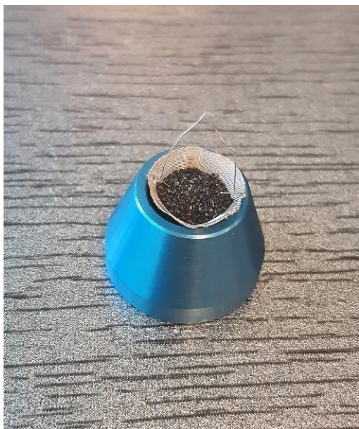
Rys. 4.2. Próbkę węgla do badań sorpcyjnych umieszczona w koszyczku pomiarowym
