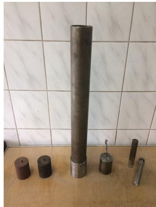
Rys. 3.4. Przyrząd do tłuczenia skał stosowany do oznaczania wskaźnika zwięzłości
