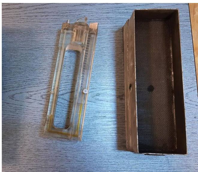
Rys. 3.5. Desorbometr manometryczny cieczowy DMC-2 wraz z dedykowanym sitem
