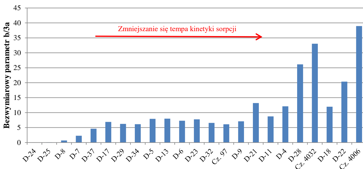
Rys. 8.3. Zestawienie bezwymiarowego parametru \frac{\beta}{3\alpha} w zależności od malejącej kinetyki sorpcji dla analizowanych prób węgla kamiennego
