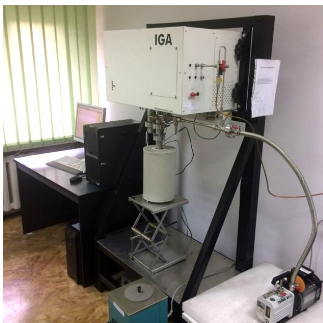
Rys. 4.1. Stanowisko do badań sorpcyjnych z grawimetrycznym systemem sorpcyjnym IGA-001 (Intelligent Gravimetric Analyser) firmy Hiden Isochema
