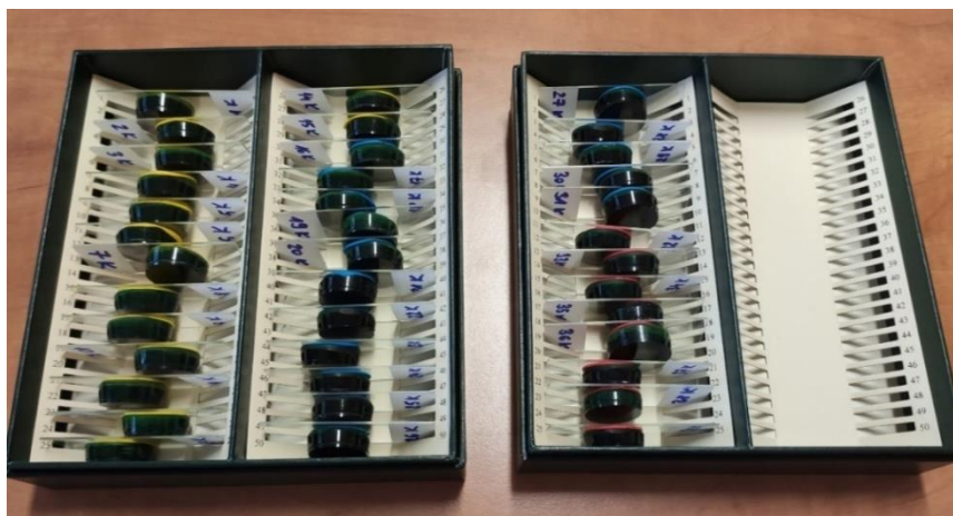
Rys. 4.7. Przygotowane polerowane preparaty ziarnowe (zgłady) do badań petrograficznych
