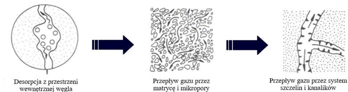
Rys. 3.6. Mechanizm przepływu gazu w węglu kamiennym (King, 1985)
