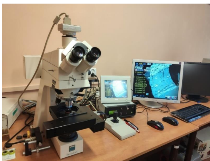
Rys. 4.8. Stanowisko do analiz mikroskopowych wraz z analizą ilościową
