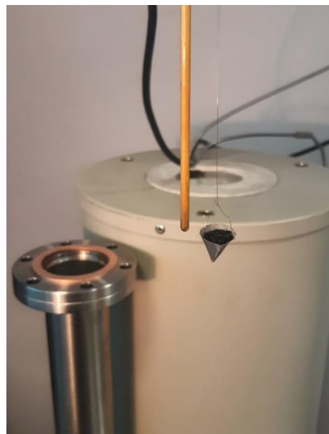
Rys. 4.3. Próbkę węgla w koszyczku pomiarowym podwieszona do mikrowagi sorpcyjnej
