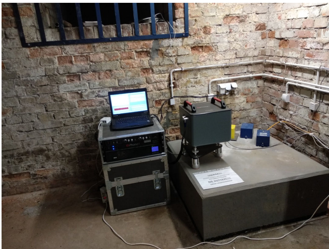
Rys. 13. Stanowisko pomiarowe w Industrialnym Centrum Kultury Zabytkowej Kopalni Ignacy w Rybniku - Niewiadomiu z grawimetrem gPhoneX-155 ( \phi = 50.062540^\circ , \lambda = 18.467134^\circ , h = 297.07\text{m n.p.m.} ).
