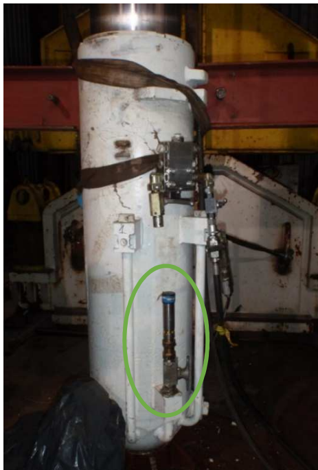
Fot. 10.9. Wariant czwarty podłączenia elementów hydraulicznych w układzie zabezpieczającym stojak (źródło własne)
