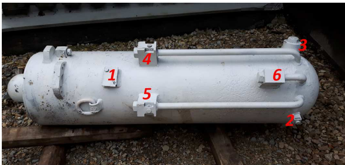
Fot. 10.4. Przygotowany do badań model stojaka wraz z dodatkowymi przyłączami (źródło własne)
