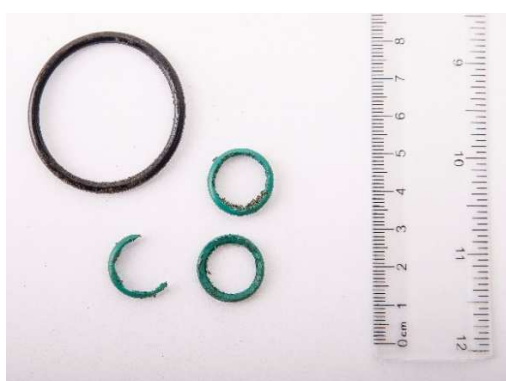
Fot. 6.3. Przykładowe uszkodzenia zaworów (źródło własne); a) uszkodzone uszczelki okrągłe zaworu, b) uszkodzone tłoczki oraz króciec zaworu
