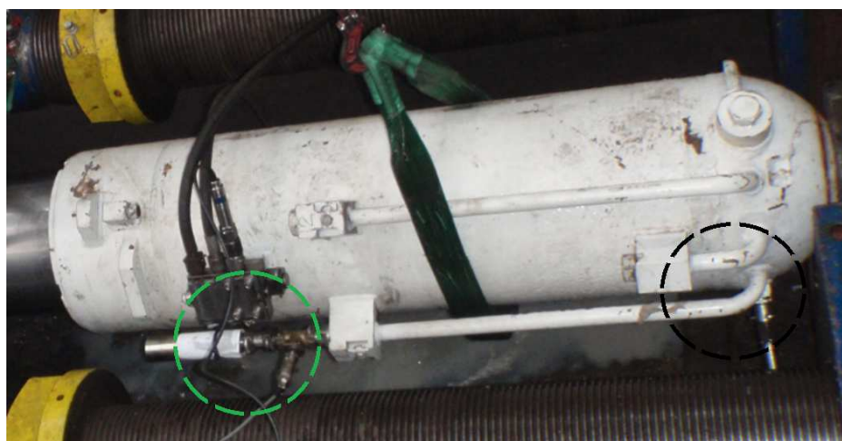
Fot. 10.14. Wariant czwarty podłączenia elementów hydraulicznych w układzie zabezpieczającym stojak (źródło własne)
