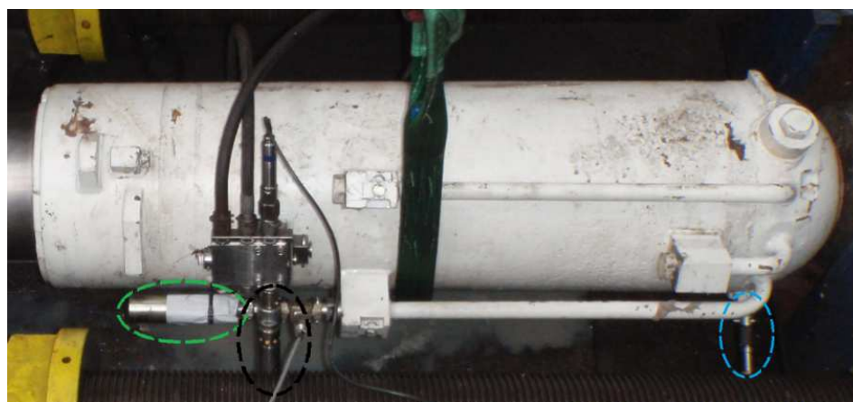
Fot. 10.15. Wariant piąty podłączenia elementów hydraulicznych w układzie zabezpieczającym stojak (źródło własne)
