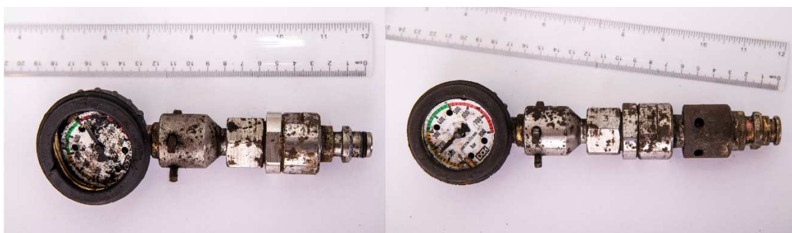
Fot. 6.1. Uszkodzone ciśnieniomierze (źródło własne)
