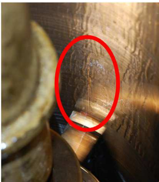
Fot. 10.3. Widoczna rysa wewnątrz cylindra honowanego stojaka o średnicy I stopnia \varnothing 0,37 m
