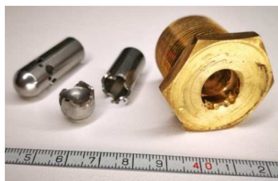
Fot. 6.3. Przykładowe uszkodzenia zaworów (źródło własne); a) uszkodzone uszczelki okrągłe zaworu, b) uszkodzone tłoczki oraz króciec zaworu
