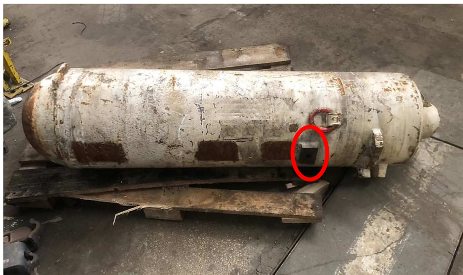
Fot. 10.1. Pozyskany do badań stojak o średnicy I stopnia \varnothing 0,32 m, z zaznaczonym oryginalnym przyłączem (wyprowadzenie cieczy z podtłoka PT wierceniami w płaszczu cylindra 3 \times \varnothing 0,008 m) (źródło własne)
