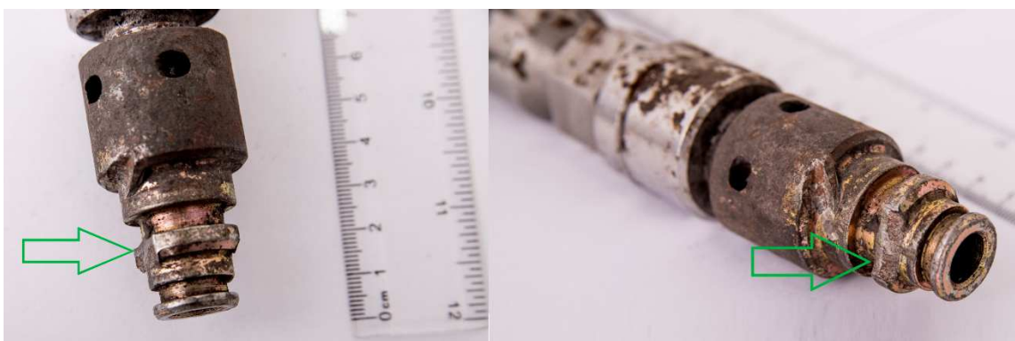
Fot. 6.5. Uszkodzone złącza Stecko DN12 (źródło własne)
