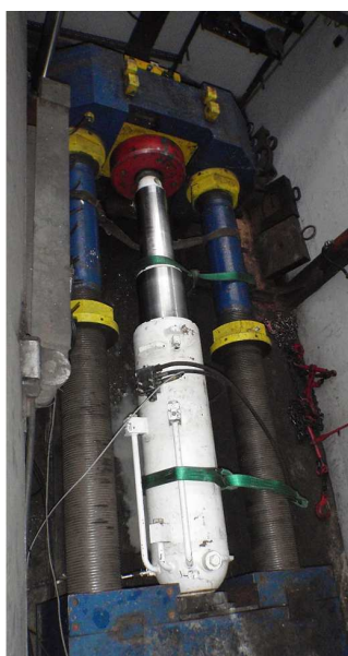
Rys. 2.12. Badanie stojaka z wykorzystaniem materiału wybuchowego, bardzo krótki czas obciążenia dynamicznego, w stanowisku ITG KOMAG; a) wygląd stanowiska (źródło własne); b) zarejestrowany przebieg ciśnienia (stojak dwuteleskopowy, średnica I stopnia \varnothing 0,32 m) (Centrum Hydrauliki DOH)
