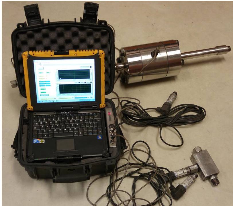
Rys. 7. Zestaw pomiarowy (laptop z kartą akwizycji danych, czujniki ciśnienia, przepływomierz)
