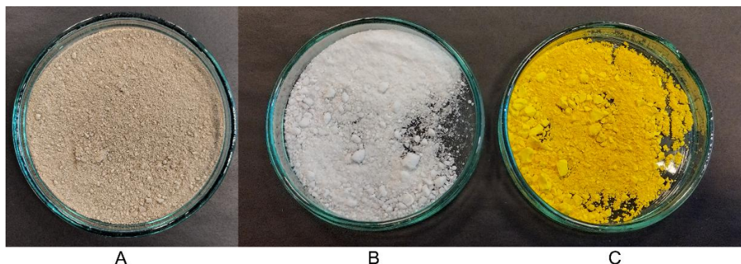
Rysunek 7. Osad wysuszony w temperaturze otoczenia (A), uzyskany chlorek ceru(III) \text{CeCl}_3 \cdot 7\text{H}_2\text{O} (B), uzyskany siarczan(VI) ceru(IV) \text{Ce}(\text{SO}_4)_2 (C) Źródło: [49]
