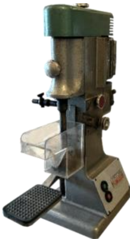
Rysunek 19. Maszynka flotacyjna typu Mechanobr o pojemności komory 1 dm 3 (źródło: www.dbc.wroc.pl )
