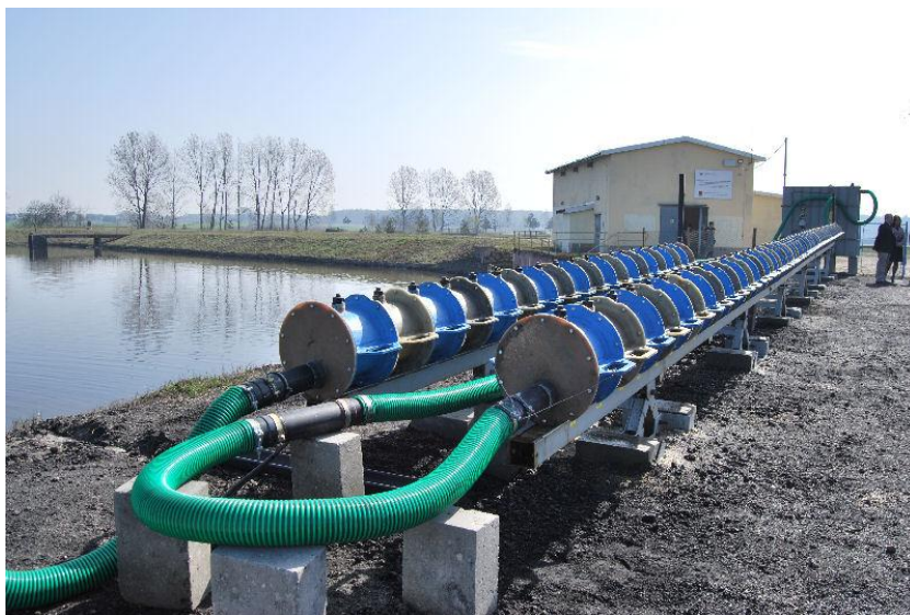
Rysunek 5. Pilotażowa instalacja oczyszczania wód z radu przy pomocy zeolitów (źródło: GIG-PIB)
