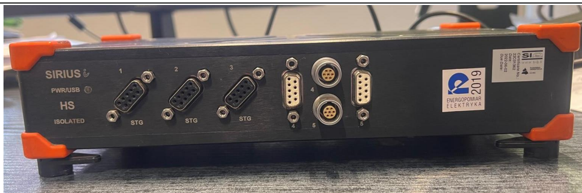
Rys. 7.21. System akwizycji Sirius HS; wejścia pomiarowe (fot. A. Toman)
