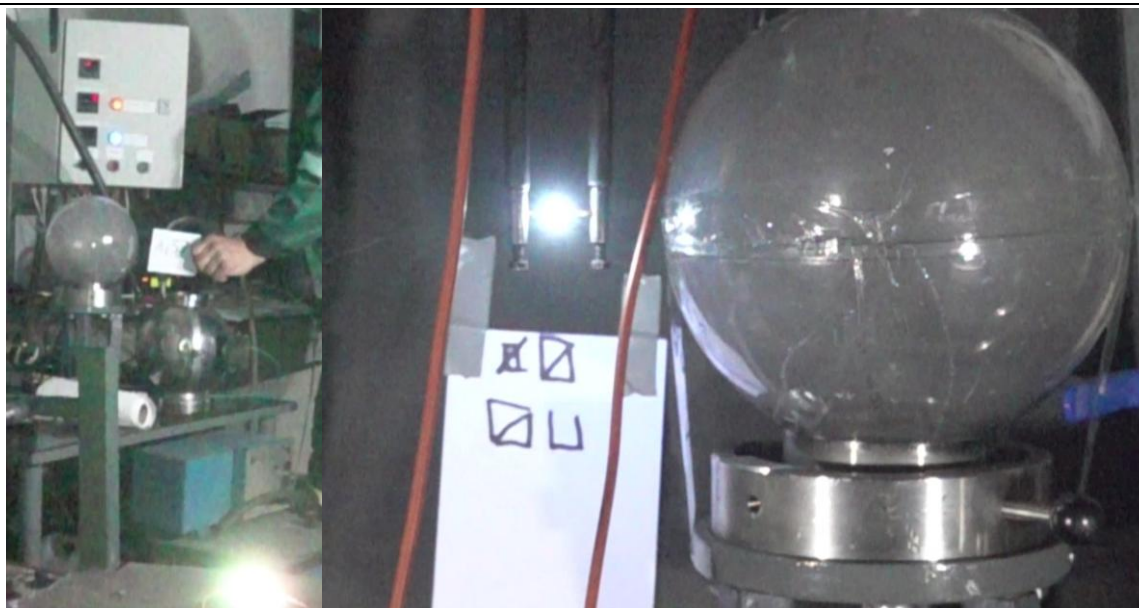
Rys. 8.20. Synchronizacja źródła zapłonu z procesem atomizacji (fot. A. Toman)
