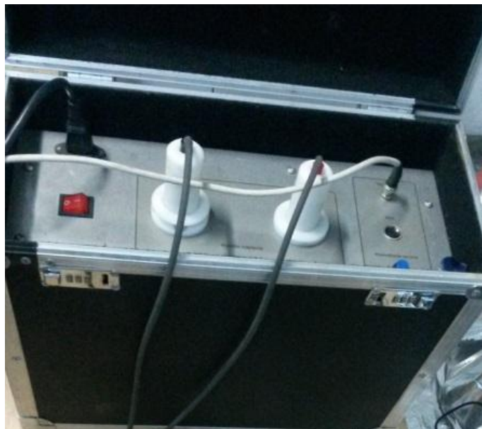
Rys. 7.14. Generator iskier indukcyjnych o energii 7 J (fot. A. Toman)
