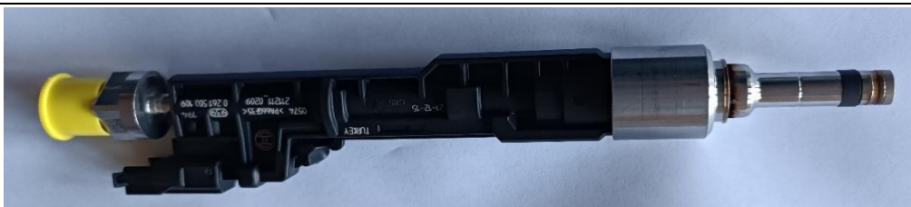
Rys. 7.10. Wtryskiwacz BOSCH HDEV 0 261 500 109 (fot. A. Toman)
