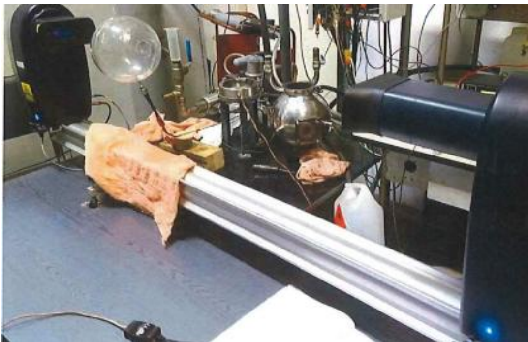
Rys. 8.7. Stanowisko pomiarowe wielkości cząstek aerozolu (fot. A. Toman)
