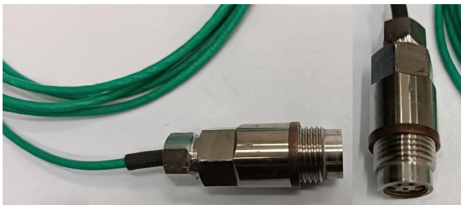
Rys. 7.22. Czujnik ciśnienia firmy Kistler 4011A020DSH, zamontowany w adapterze (fot. A. Toman)
