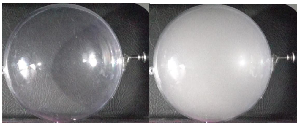
Rys. 7.11. Przezroczysta komora sferyczna i rozproszony aerosol nafty o koncentracji 336 \text{ g/m}^3 (fot. A. Toman)
