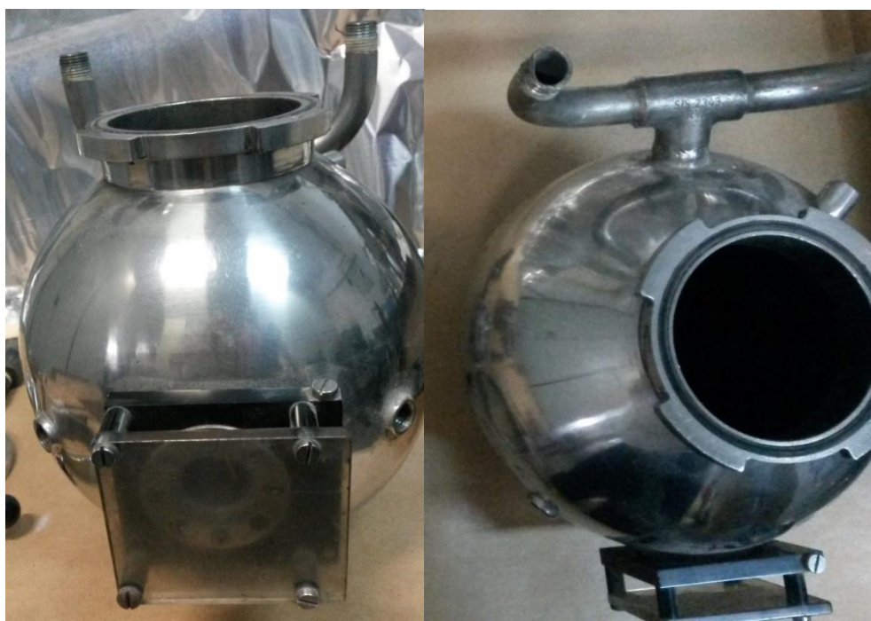
Rys. 7.2. Komora badawcza 5 dm 3 (fot. A. Toman)
