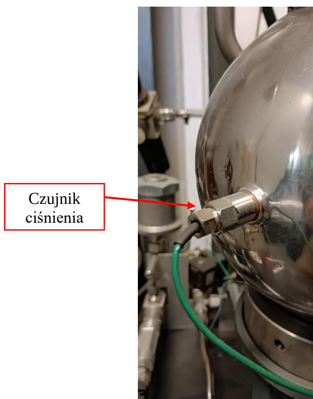
Rys. 7.24. Umieszczenie czujnika ciśnienia w komorze badawczej (fot. A. Toman)
