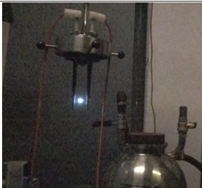
Rys. 7.15. Wyładowanie iskrowe pomiędzy elektrodami z generatora indukcyjnego (fot. A. Toman)
