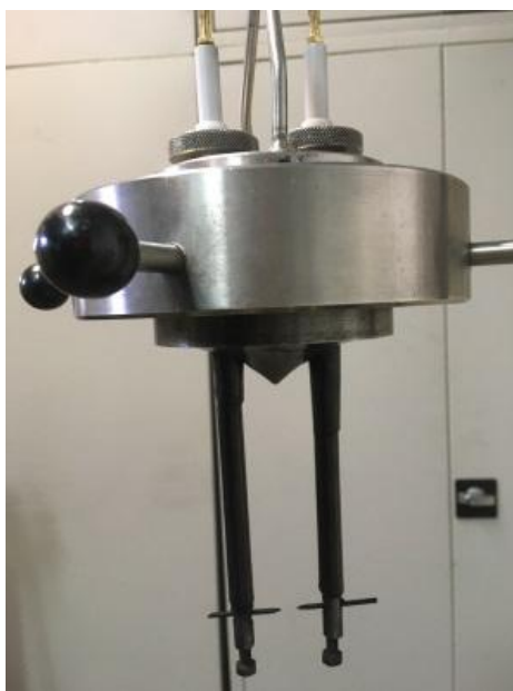
Rys. 7.3. Górny adapter komory z elektrodami zapłonowymi (fot. A. Toman)
