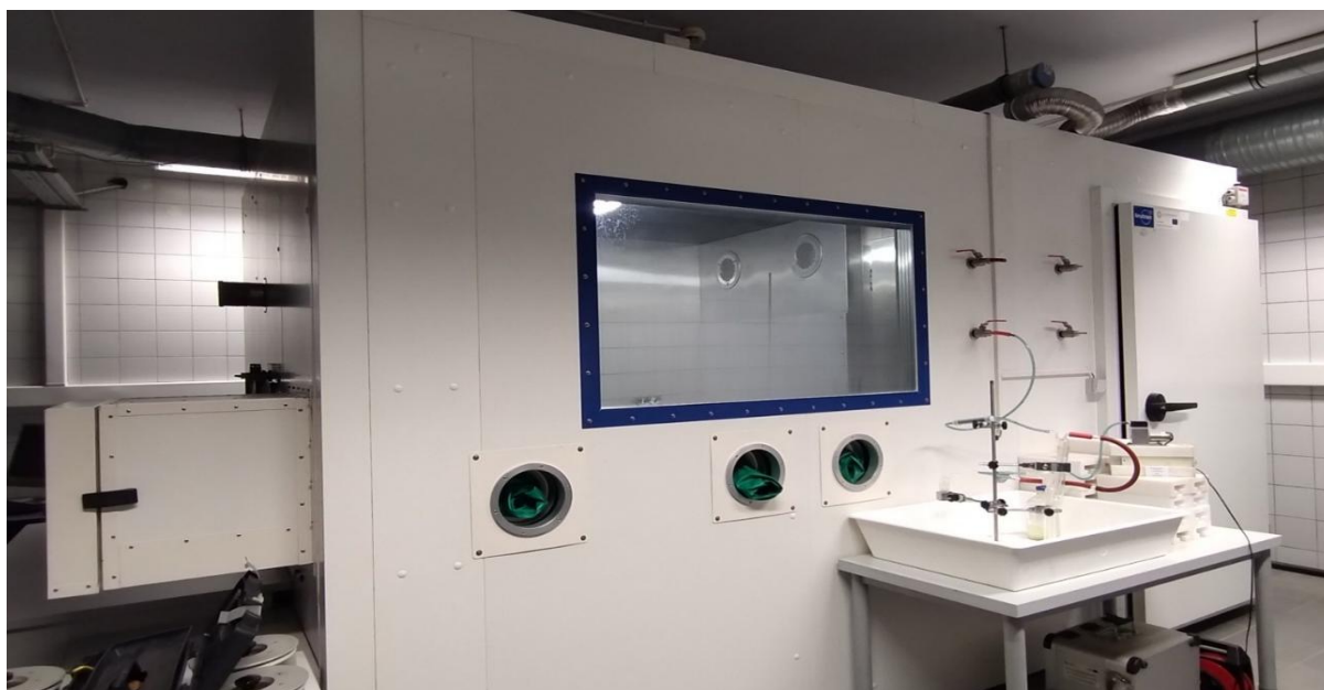
Rys. 9. Komora radonowa Śląskiego Centrum Radiometrii GIG-PIB
