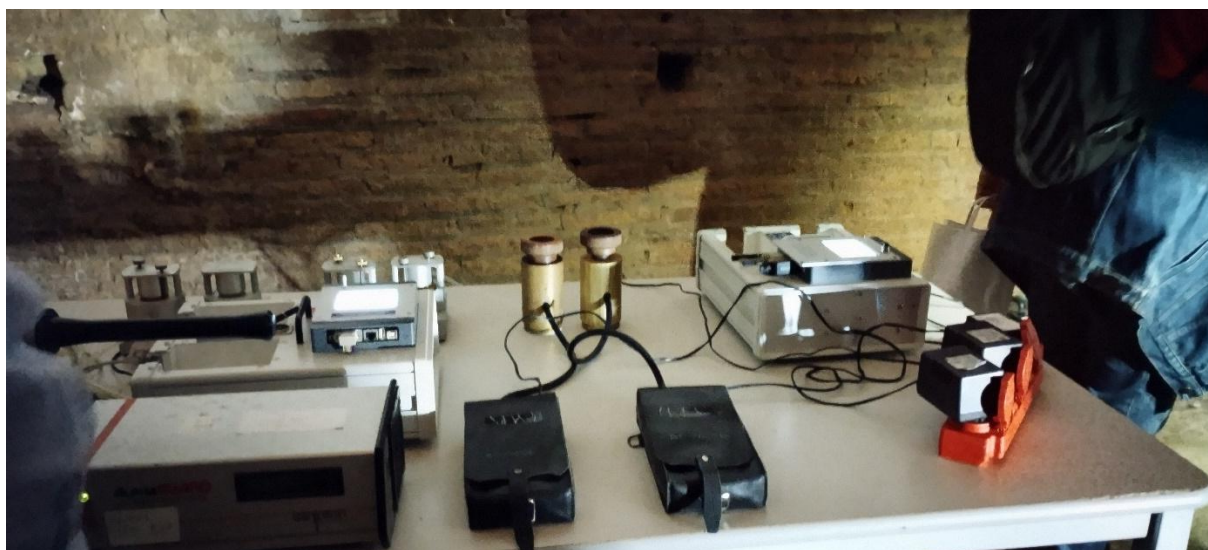
Rys. 25. Jednoczesny pomiar stężenia energii potencjalnej alfa produktów rozpadu radonu i toronu (zdjęcie własne)
