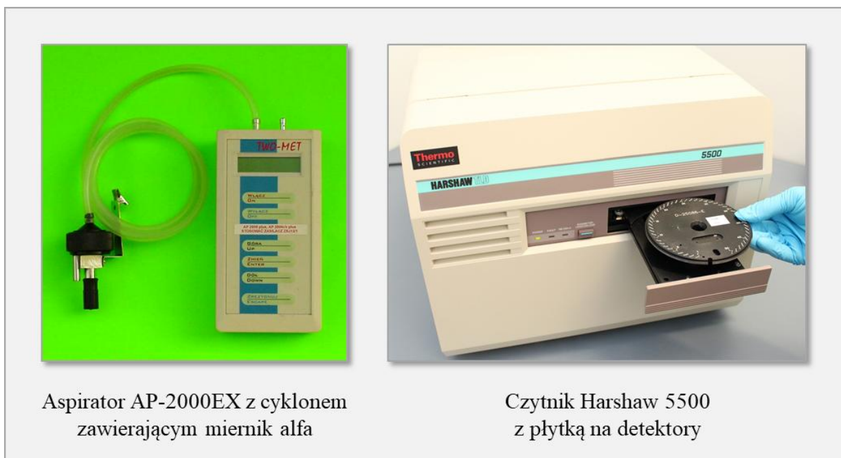
Rys. 7. Aspirator AP-2000 EX i czytnik detektorów TL Harshaw-5500 (zdjęcie własne)
