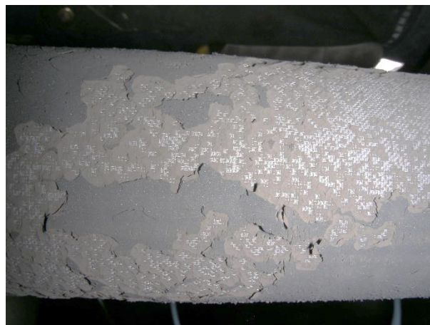
Rys. 3.13 Stan wkładu F_M_02 po zakończonym teście filtracji.
