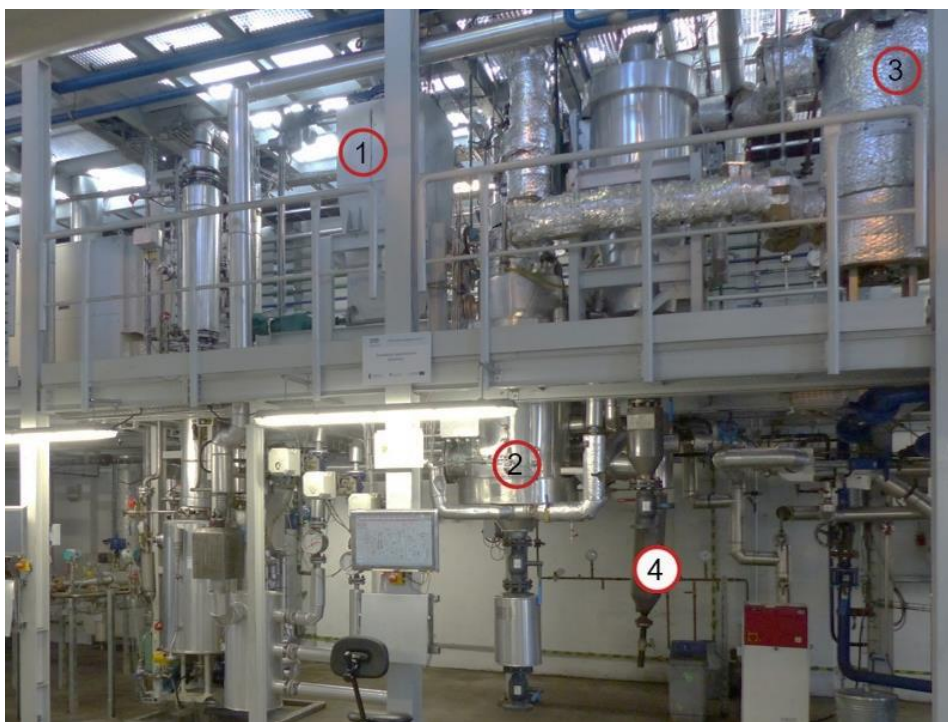
Rys. 3.2 Zdjęcie pilotażowej instalacji zgazowania z zaznaczonymi głównymi aparatami: 1) układ podawania paliwa, 2) reaktor zgazowania, 3) filtr gazu procesowego, 4) chłodnica.
