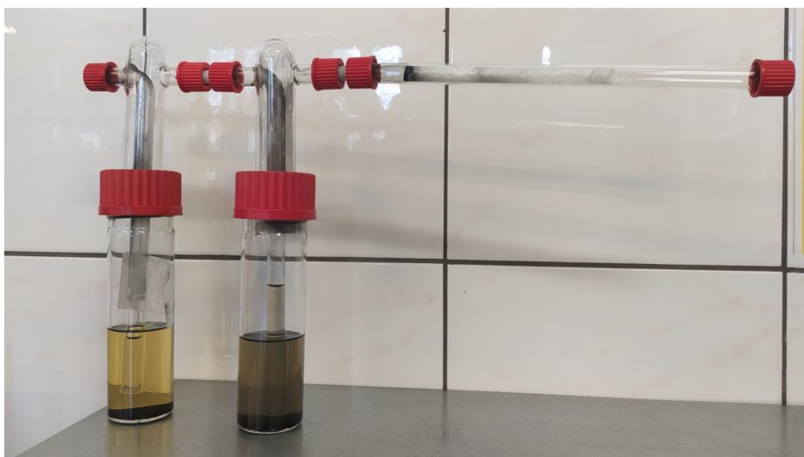
Rys. 3.7 Zestaw poborowy do oznaczania zawartości wody, związków organicznych oraz pyłów zawartych w gazie procesowym – po zrealizowanym poborze.
